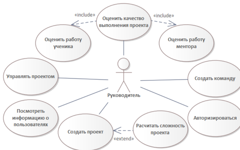
Рисунок 1 – Диаграмма вариантов использования цифровой платформы управления профориентационными IT-проектами руководителем
